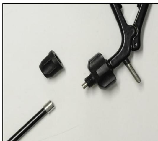
Den Kunststoffkörper nicht mit dem Strahl behandeln. Zerlegen Sie die verschiedenen Teile, um die Metallspitzen zu behandeln, und spülen Sie die Kunststoffteile mit Wasser ab.
