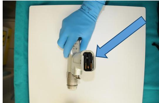
Achten Sie auf die elektrischen Anschlüsse, verwenden Sie keinen Bikarbonatstrahl, sondern spülen Sie lediglich.
