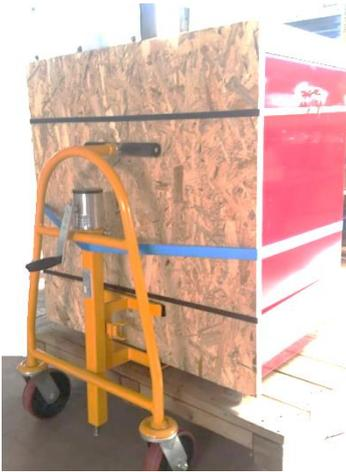
Nach dem Öffnen der Kiste wird das Gerät mit einer speziellen Vorrichtung zum Bewegen von Möbeln angehoben.
