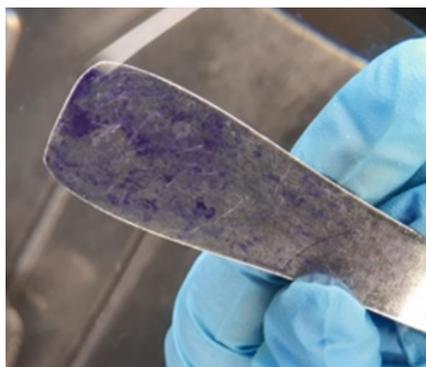
Figure 1 : Détection des souillures résiduelles après lavage (OneLIFE DETECT®)
