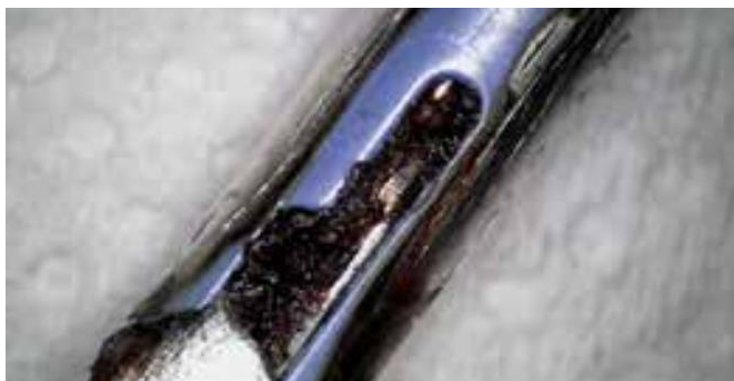
Detail van een laparoscopische pincet vóór de BICAR med ® -behandeling
