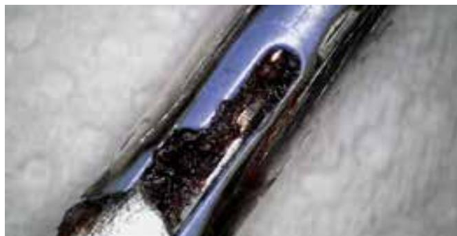
Détail d'une pince laparoscopique avant le traitement BICARmed®
