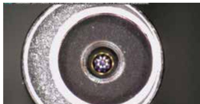
Detailaufnahme derselben Optik nach der BICAR med -Behandlung
